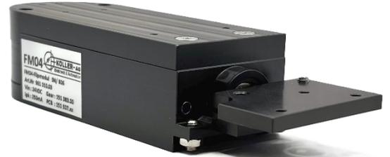
Das **Flipmodul FM04** ist ein leichtes, elektrisch angetriebenes Schwenkmodul für Wafer-Greifer mit 180° Schwenkbewegung. Ein präzise einstellbarer Endanschlag sowie Soft- und Hardaufschlag in den Endpositionen sorgen für exaktes und schonendes Positionieren.
